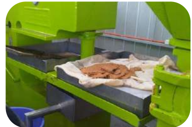
6- Prensa neumática con 2 bandejas una de prensado y la otra de armado de paños para prensar.
