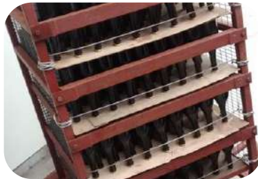
14- Canastillo volteador de botellas en segunda fermentación manual.
