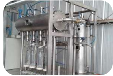
12- Llenadora isobarométrica de 4 unidades con sistema de carbonatación.
