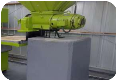
4- Molino eléctrico con cuchillos de acero inoxidable.
