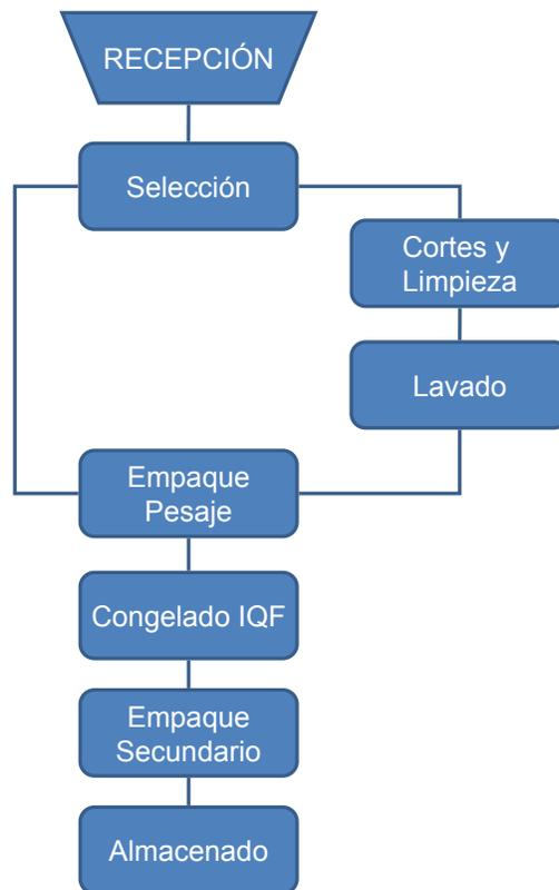
Figura 34: Esquema del proceso para línea congelado.
