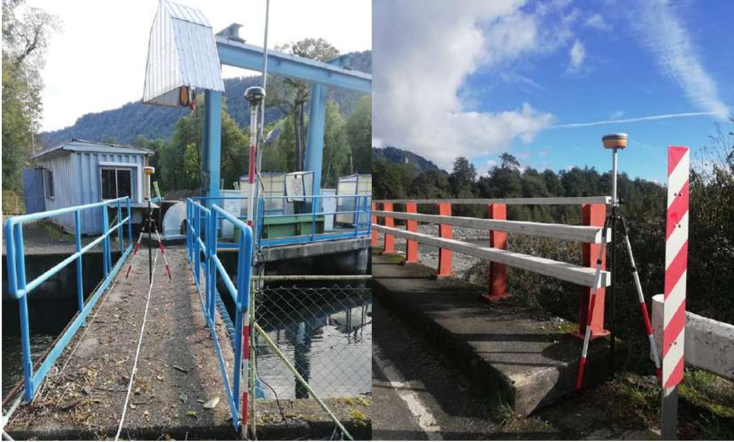
**Figura 3:** Mediciones estáticas GNSS de puntos representativos imagen satelital Google Earth con equipos geodésicos doble frecuencia.
