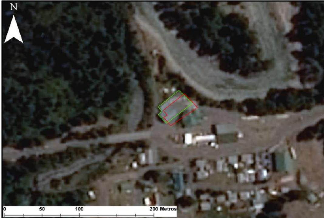
**Figura 53:** Desplazamiento de la imagen Spot 7 al ser georreferenciada. El polígono en rojo representa el contorno de un edificio del complejo fronterizo Cardenal Samoré trazado sobre la imagen sin georreferenciación; el polígono en verde representa el mismo edificio, pero trazado sobre la imagen georreferenciada. Imagen de fondo: Spot 7, Datum WGS-84, proyección UTM 18S.
