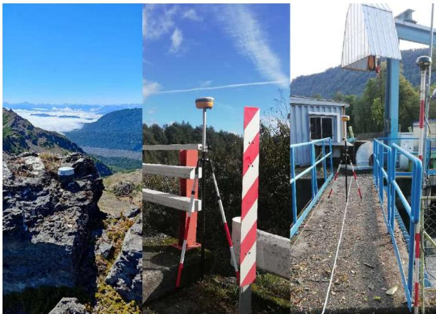
**Figura 37:** Mediciones estáticas GNSS de puntos representativos imagen satelital Google Earth y SPOT7 con equipos geodésicos doble frecuencia.
