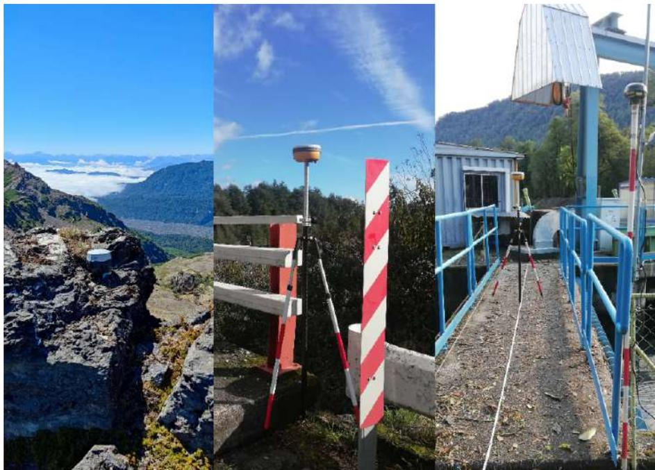
**Figura 64:** Mediciones estáticas GNSS de puntos representativos imagen satelital Google Earth y SPOT7 con equipos geodésicos doble frecuencia.
