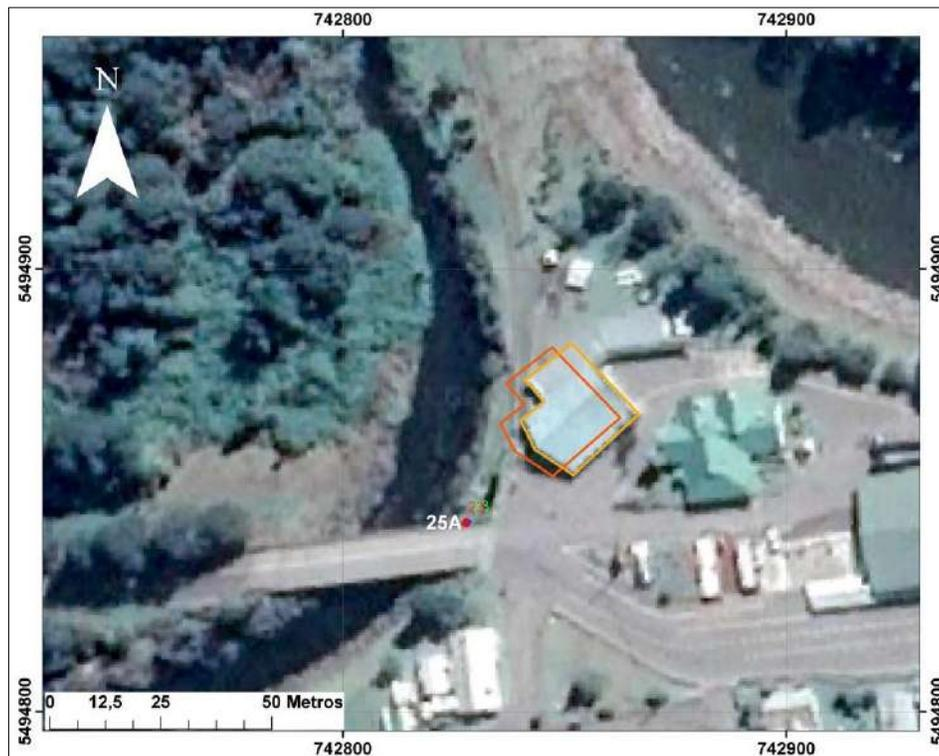
**Figura 10:** Desplazamiento de la imagen al ser georreferenciada. El polígono en rojo representa el contorno de un edificio del complejo fronterizo Cardenal Samoré trazado sobre la imagen sin georreferenciación; el polígono en amarillo representa el mismo edificio, pero trazado sobre la imagen georreferenciada. Imagen de fondo: Mosaico Google Earth, Datum WGS-84, proyección UTM 18S.
